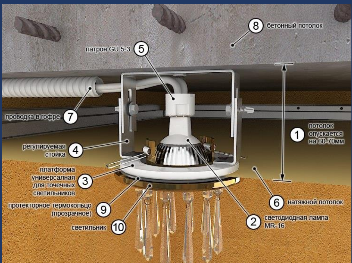
Крепление светильника к натяжному потолку
