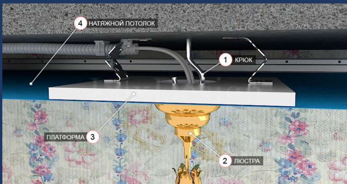
Схема установки люстры на натяжной потолок
